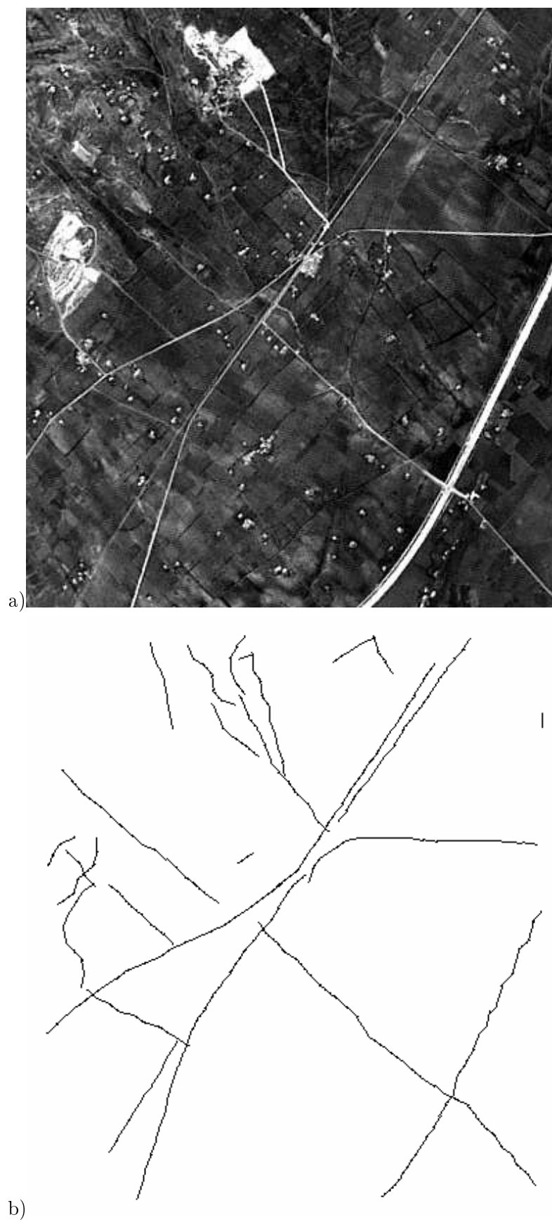
FIG. 6.9 – Extraction des routes : a) images SPOT T5 ; b) réseau routier détecté
